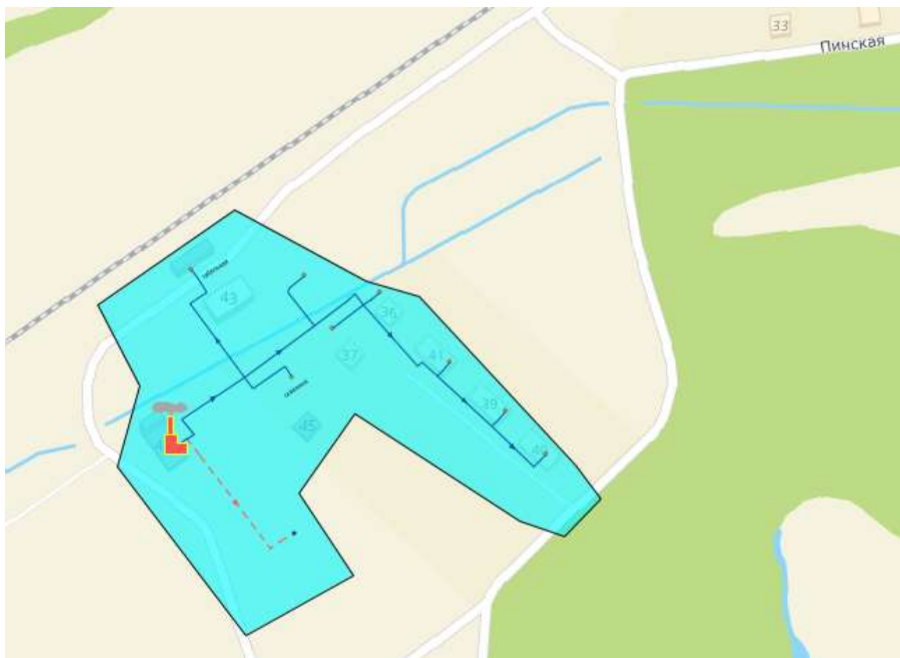
Рисунок 2.17 – Зона действия котельной №3 п. Абагур-Лесной
