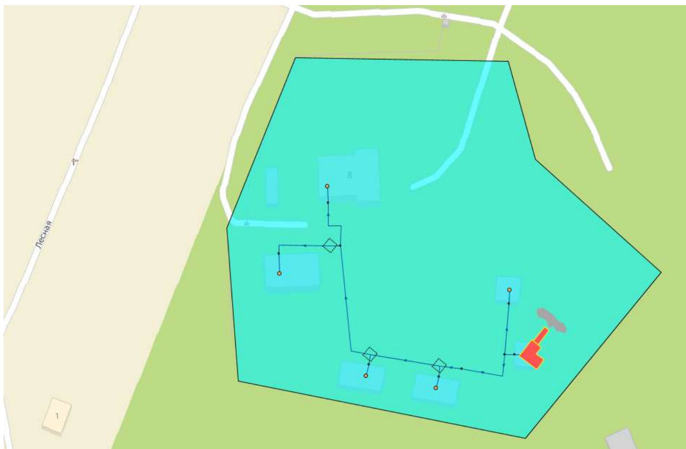
Рисунок 2.25 – Зона действия котельной ОЦ «Голубь»
